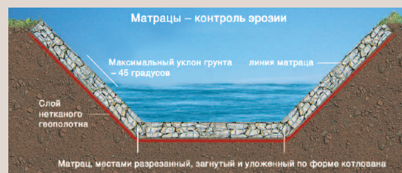
Укрепление берега матрацами из решетки Weldmesh® - Чешув, Польша - 2005 г.
