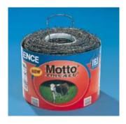
Колючая проволока из стали диаметром 1,70 мм, двойное сплетение, с кольцами через 100 мм. Слой покрытия из цинка и алюминия.
