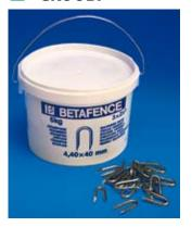
Стальные скобы с покрытием из цинка и алюминия трех диаметров (3,4; 3,9 и 4,4 мм). Используются для монтажа сетки и колючей проволоки на деревянных столбах. Упаковка в ведрах по 5 кг.
